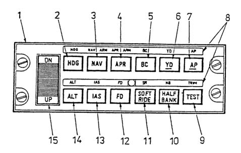
Fig. 1 KMC 321 AUTOPILOT MODE CONTROLLER
