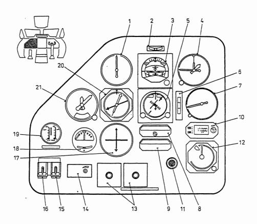
Fig. 7 - 10 LH instrument panel
