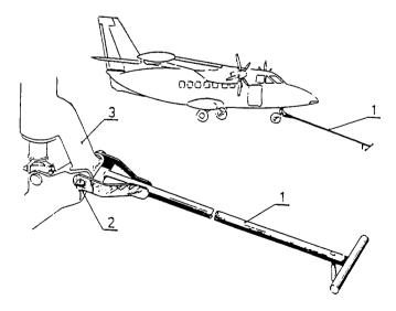
Fig. 8 – 2 Manual bar B 592 053 N (L410.9521)
