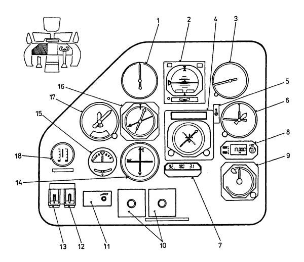
Fig. 6 LH instrument panel
